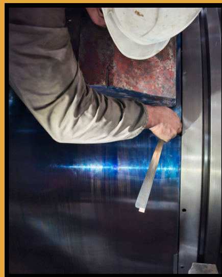
CONTRÔLE DU JEU DE COUSSINET
