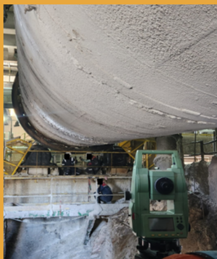
RÈGLAGE DE LA TRAINGULATION
