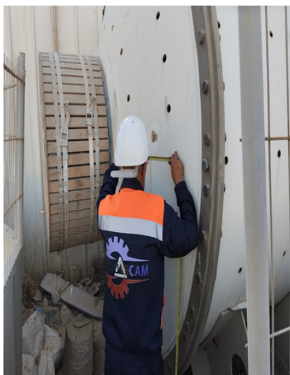
CONTRÔLE COMPLET DE LA VIROLE
